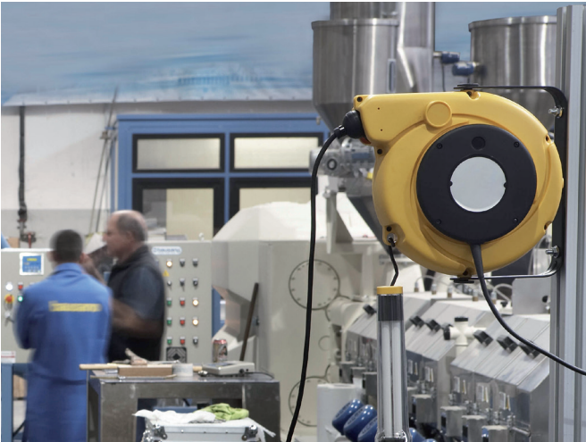
Tambour de câble avec ressort pré-équipé et pré-réglé
